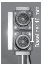
図 1: ステレオビジョンシステム：(a) システム構成, (b) ステレオカメラヘッドとその仕様
