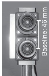
図 2: ステレオビジョンシステム：(a) システム構成， (b) ステレオカメラヘッドとその仕様
