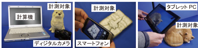
図 9 計測システムの構成例：(a) 汎用デジタルカメラと計算機, (b) スマートフォン, (c) タブレット端末 Example of measurement system: (a) Consumer digital camera and computer, (b) Smartphone, (c) Tablet computer.
