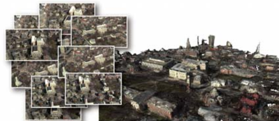
カメラで撮影した大量の画像から3次元形状を復元する
