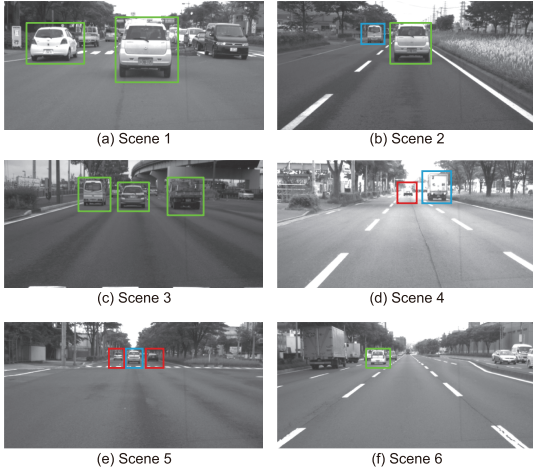
図 6 入力画像 (左カメラ) と検出対象の障害物：近距離 (10~40m: 緑), 中距離 (40~70m: 青), 遠距離 (70~110m: 赤)
